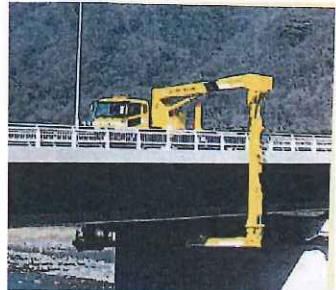
最大地上高さは16.1m最大作業半径11.4m 高性能の三段伸縮ブーム搭載!!
