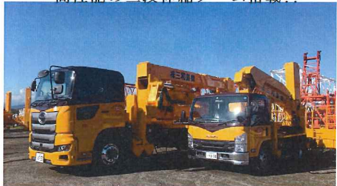
最大地上高さは16.1m最大作業半径11.4m 高性能の三段伸縮ブーム搭載!!
