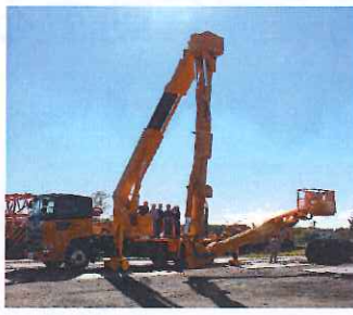
最大地上高さは16.1m最大作業半径11.4m 高性能の三段伸縮ブーム搭載!!
