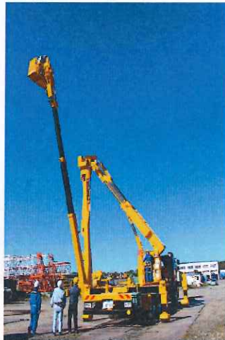
差し込み長さ15m最大地下深さ17.4m 国内最大級のブリッジチェッカー!!
