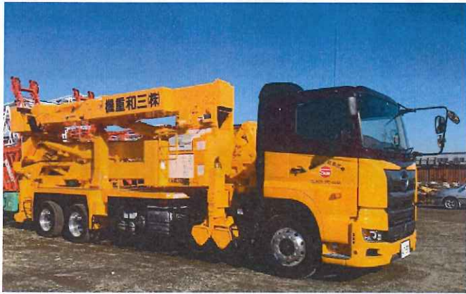
差し込み長さ15m最大地下深さ17.4m 国内最大級のブリッジチェッカー!!
