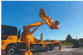
差し込み長さ15m最大地下深さ17.4m 国内最大級のブリッジチェッカー!!
