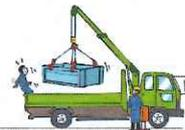
災害：積載型クレーンの巻上用ワイヤーが切れて吊り荷が落下し作業者に激突した。
